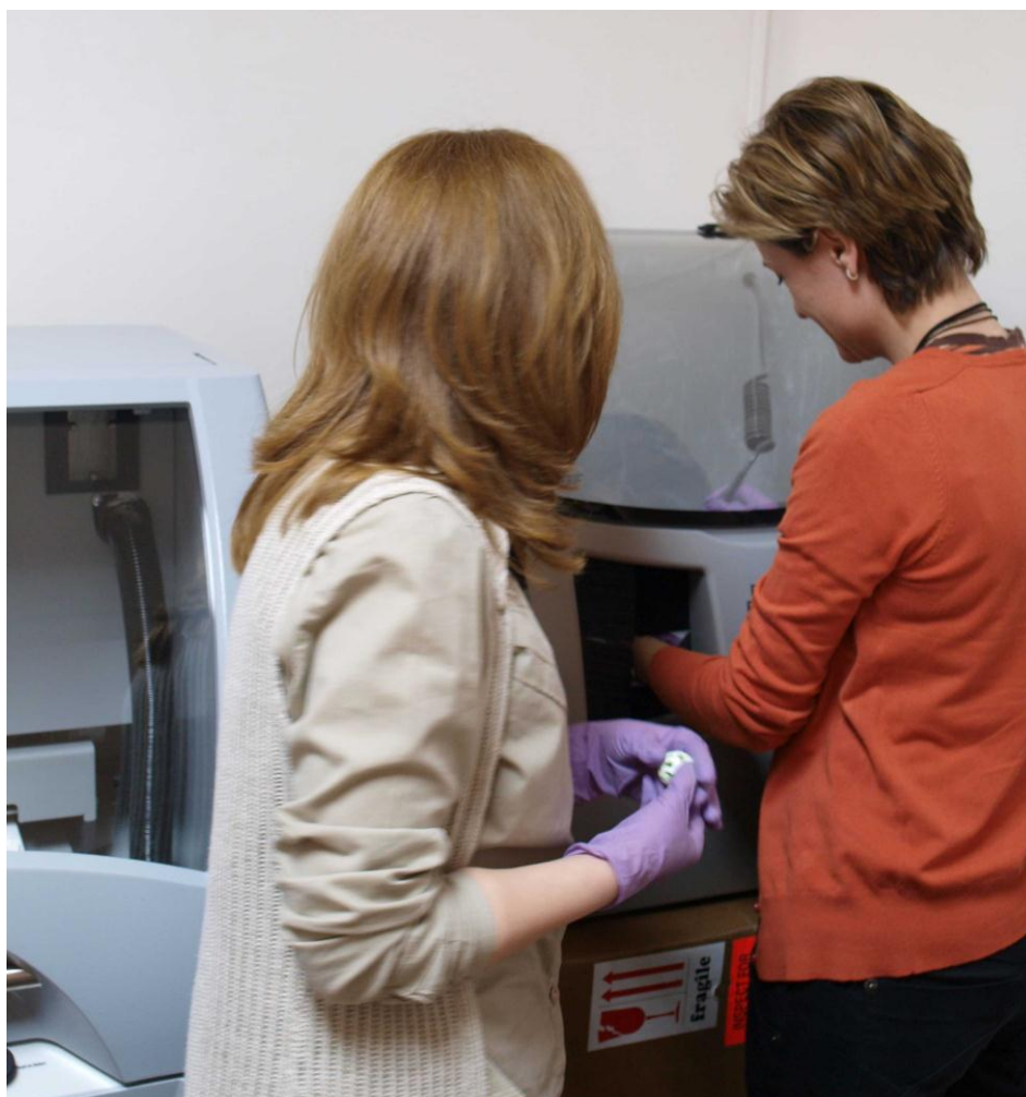
Чишћење модела у рециклатору од вишка праха који се врћа у процес
